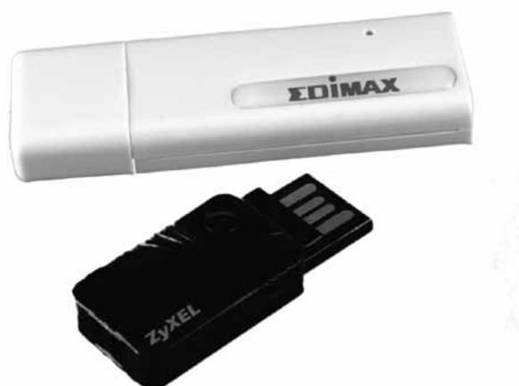
Figura 1.8 – Dois adaptadores wireless USB, convenientes para uso com o Raspberry Pi.
