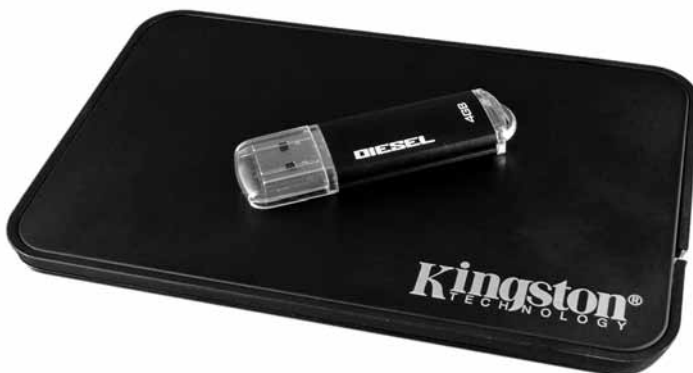
Figura 1.6 – Dois dispositivos USB Mass Storage: um pendrive e um disco rígido externo.
